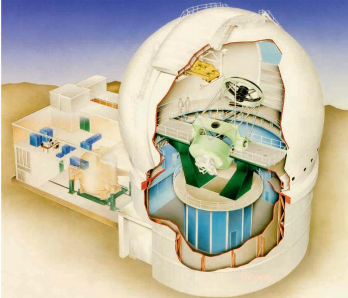
Gracias a la incorporación de un elemento corrector de 3 lentes el campo de visión útil en el foco primario es de 40 minutos de arco. La razón focal en este foco es  $f/2.8$ .
