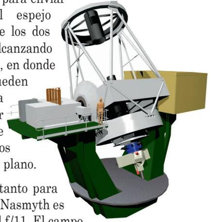
La longitud focal efectiva tanto para el foco Cassegrain como los Nasmyth es de 46.2 metros o razón focal  $f/11$ . El campo de visión sin obstrucción del Cassegrain directo es de 15 minutos de arco, y de 5 minutos de arco en los Nasmyth y Cassegrain fuera de eje.
