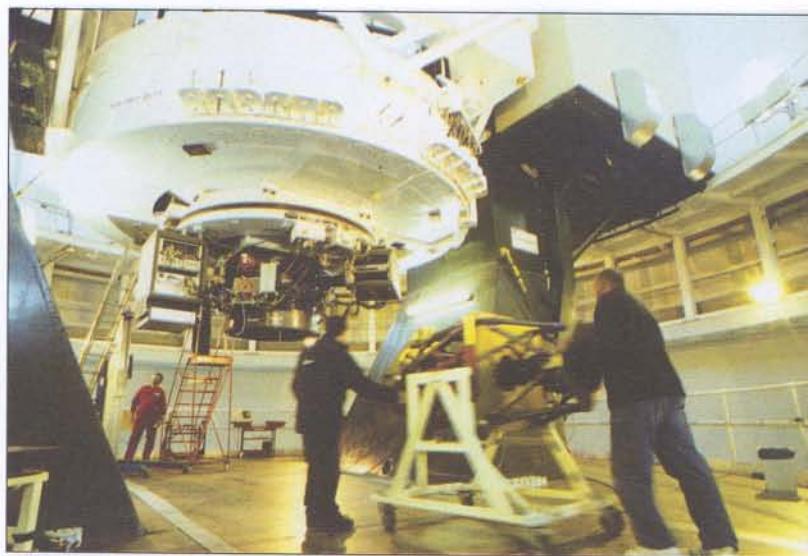
Figura 4. El equipo de mantenimiento cambiando la instrumentación en el foco Cassegrain del William Herschel.
