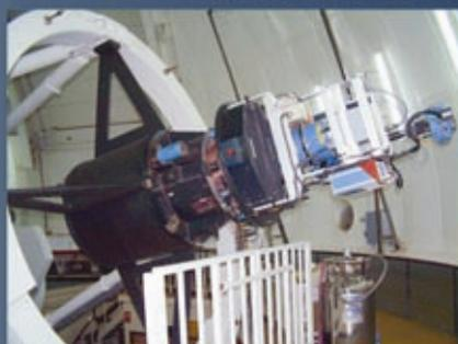
El instrumento en uso en el INT en la actualidad es la Wide Field Camera (WFC), o Cámara de Gran Campo, instalada en el foco primario. Esta cámara posee un avanzado mosaico CCD que le permite obtener imágenes con un campo de visión aproximado de  $0,5 \times 0,5$  grados. La WFC ofrece unas posibilidades únicas para la ejecución de programas de larga duración en el rango visible de las longitudes de onda obteniendo imágenes profundas de gran campo con alta resolución.
