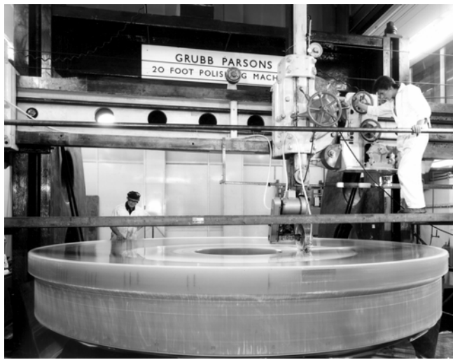
Construcción del telescopio William Herschel. Pulido del bloque del espejo en Grubb Parsons en 1983. Fotografía procedente del archivo de Nei Grubb Parsons Limited.
